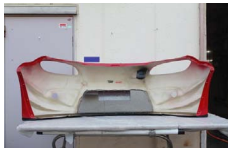
ダクト裏側 FRP製の導入ダクト付
