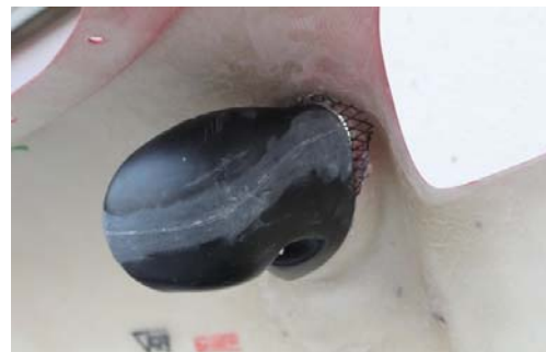
ダクト裏側 FRP製の導入ダクト付
